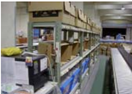
小仕分け ボカヨケセンサーで、誤投入防止
